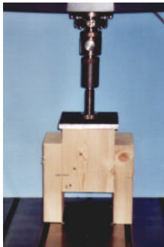
Fig. 11 : Prova con quattro connettori WT sollecitati a taglio
