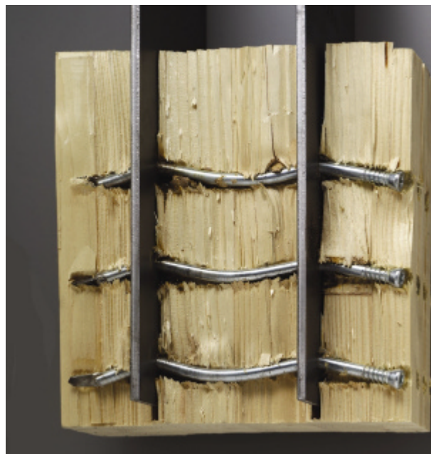
Fig. 7: comportamento a rottura ideale per assemblaggio legno-acciaio a sezioni multiple a taglio
