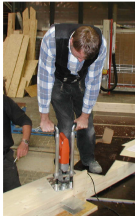
Fig. 5: strumento di posa manuale CF WS/M
