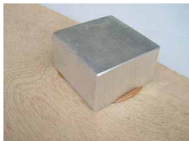
LASCIARE LA PIASTRA DI RAFFREDDAMENTO SOPRA IL KNOT FILLER. LA PIASTRA SERVE SIA COME PESO PER SPINGERE IN PROFONDITÀ IL PRODOTTO, SIA PER RIDURRE ULTERIORMENTE I TEMPI DI INDURIMENTO
