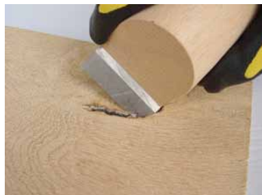
TOGLIERE I RESIDUI DEL NODO CON IL PIALLETTO
