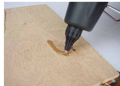
INIETTARE IL KNOT FILLER SOMMARIAMENTE SOPRA IL FORO DA RIPARARE
