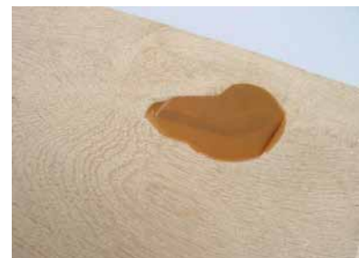
BASTANO POCHI SECONDI E LA PIASTRA DI RAFFREDDAMENTO SI STACCHERÀ FACILMENTE. IL TEMPO DI INDURIMENTO VARIA ANCHE A SECONDA DELLO SPESSORE DEL KNOT FILLER INIETTATO
