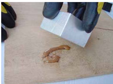
POSIZIONARE LA PIASTRA DI RAFFREDDAMENTO SOPRA IL KNOT FILLER
