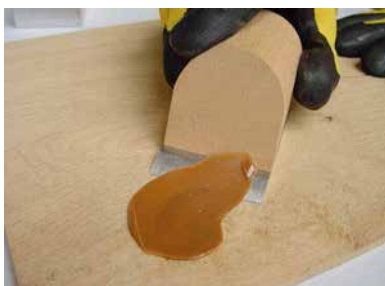
TOGLIERE CON IL PIALLETTO IL MATERIALE IN ECCESSO
