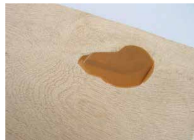
BASTANO POCCHI SECONDI E LA PIASTRA DI RAFFREDDAMENTO SI STACCHERÀ FACILMENTE. IL TEMPO DI INDURIMENTO VARIA ANCHE A SECONDA DELLO SPESSORE DEL KNOT FILLER INIETTATO
